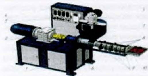
Рисунок 1. Основные узлы экструдера: 1 – станина, 2 - силовой привод вращения шнека, 3 - силовой привод ворошителя, 4 - шкаф управления, 5 - панель управления, 6 - корпус шнека, 7 - загрузочный бункер, 8 – нагреватели, 9 - держатели термопар, 10 – фильера.
