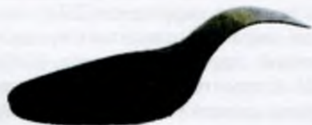
Рисунок 2. Подошва, изготовленная из отходов пенополиуретанов с волокнистым наполнителем (кноп)
