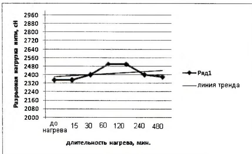
Рис. 2. Графическая зависимость прочности комбинированной нити от длительности нагрева
