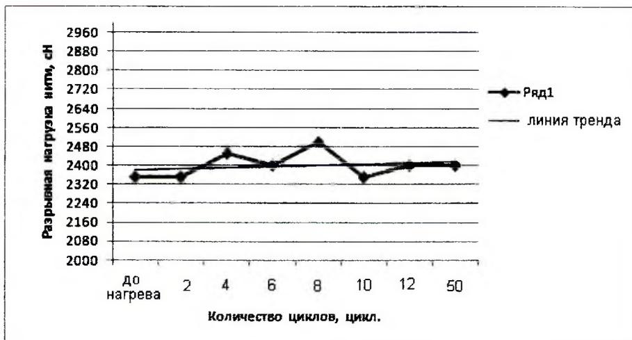
Рис. 3. Графическая зависимость прочности комбинированной нити при многоцикловом способе нагрева
