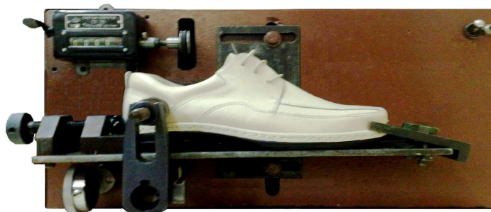
Рисунок 1 – Внешний вид прибора ППНМО с закрепленным образцом
