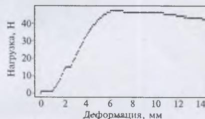
Рис. 1. Зависимость нагрузки при изгибе от деформации обувного картона.
