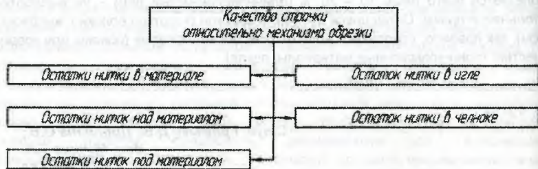
Рисунок – Критерии качества строчки, получаемой в процессе обрезки нитки
