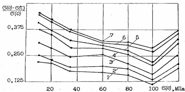
Рис. 3. Изохронные зависимости относительного изменения напряжения от начального напряжения для СЦМ:
