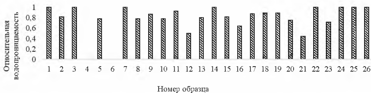
Рис. 2. Относительная водопроницаемость образцов ММ после изгиба
