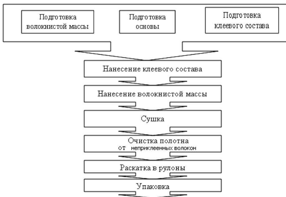
Рис. 4. Упрощенная схема технологического процесса изготовления композиционных рулонных материалов
