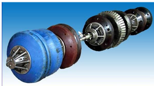
Рис. 2. Снаряд-дефектоскоп для внутритрубной диагностики магистральных трубопроводов
