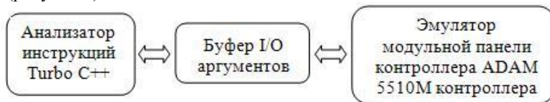
Рис. 1. Программно-алгоритмическая структура эмулятора контроллера ADAM 5510M
