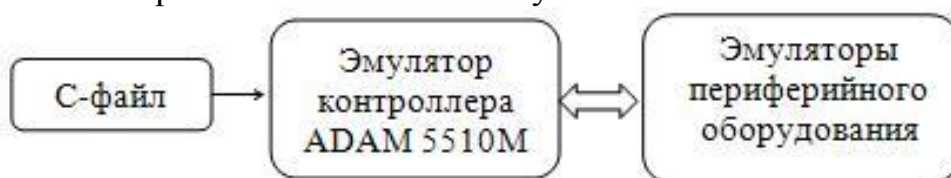
Рис. 2. Схема моделирования систем управления с использованием внешних эмуляторов управляемого оборудования
