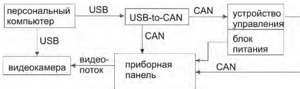
Рис. 2. Схема программно-аппаратного комплекса
