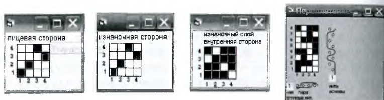
Рис. 3. Построение переплетения полутораслойной ткани с дополнительным утком
