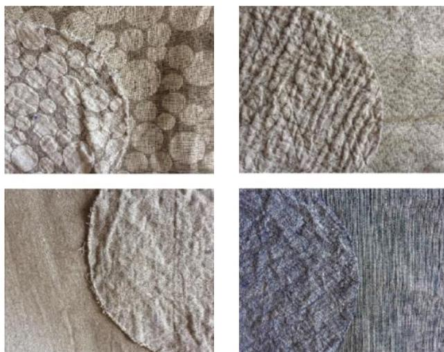
**Рисунок 2 – Фотографии льняных материалов до и после ферментной обработки**
