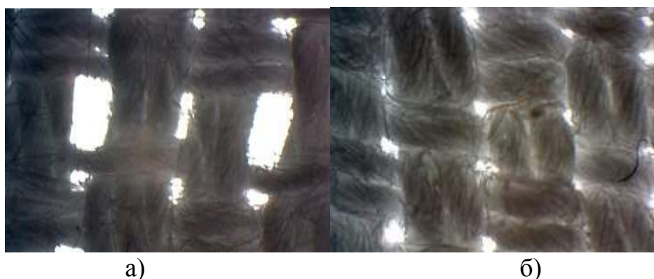
Рисунок 3 – Микрофотография среза кромки махровых изделий, изготовленных из хлопкольнайной пряжи а) подготовленной по традиционной технологии б) подготовленной по биотехнологии
