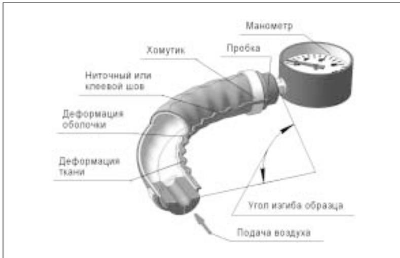
**Рис. 1.** Принципиальная схема узла нагружения прибора для испытания эластичных материалов и швов
