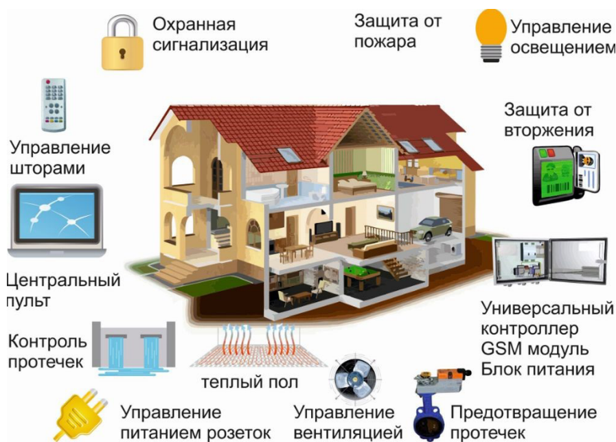
Рисунок 1 – Схема «Умного дома»
