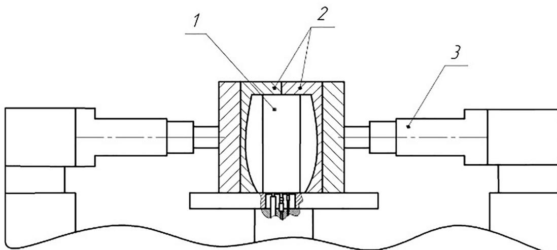
**Рисунок 1 – Установка для высокоскоростной штамповки взрывом**
