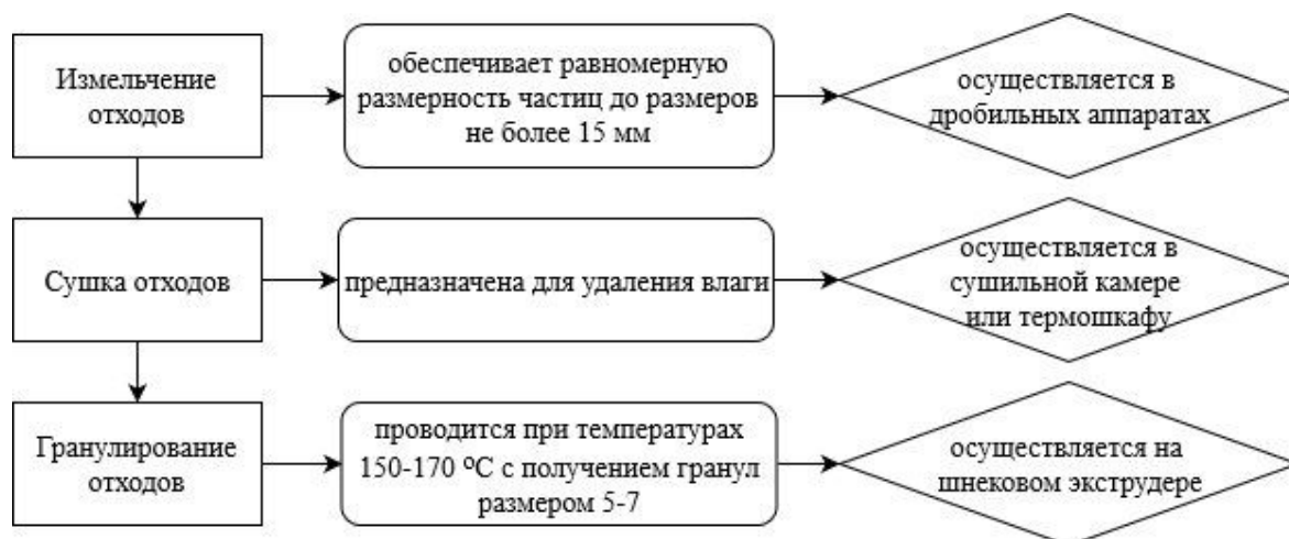
Рис. 1. Технологическая схема основных операций получения гранулята
