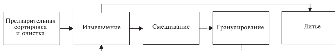
Рис. 2. Этапы технологии получения изделий на основе вторичного ППУ.
