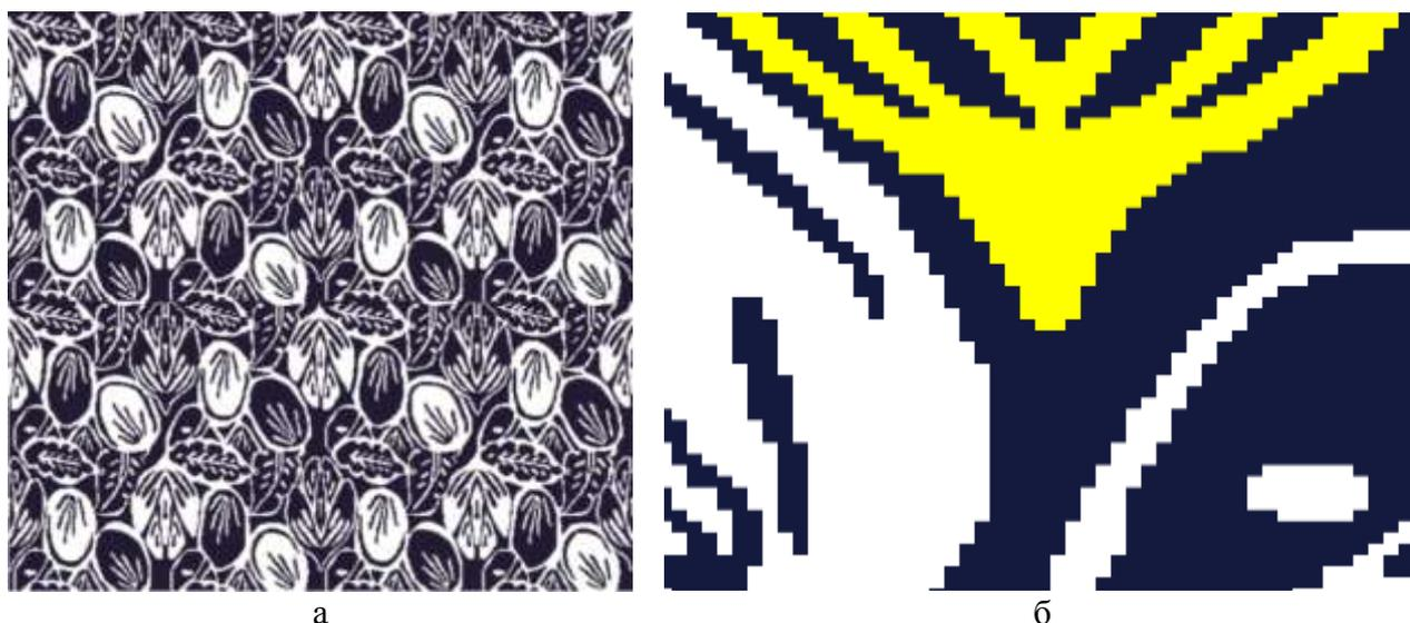
Рисунок 2 – Эскиз (а), фрагмент патрона (б) жаккардовой ткани
