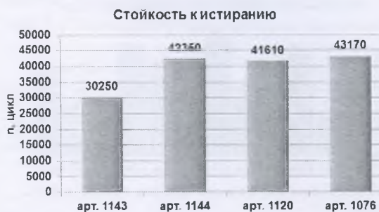
Рис. 5. Стойкость к истиранию ткани при сухом трении серошинельным сукном
