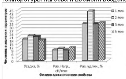
Рисунок 2 - Графическая зависимость физико-механических свойств КВУН от времени воздействия на образец в горячем паре
