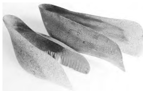
Рис. 1. Внешний вид обувных картонов и задников: а – листы обувного картона; б – формованный и полуформованный задник
