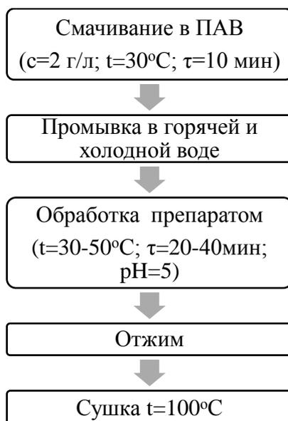
Рисунок 1 – Схема обработки ткани
