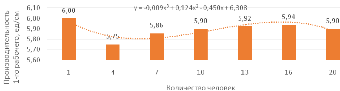
Рисунок 1 – График зависимости производительности труда 1-го рабочего от количества рабочих в бригаде (потоке)
