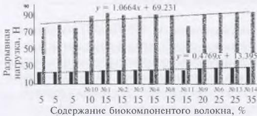
Рис. 3. Зависимость разрывной нагрузки ШНП из РВ по длине и ширине от содержания бикомпонентного волокна марки 4DE51 Слон в смеси.
