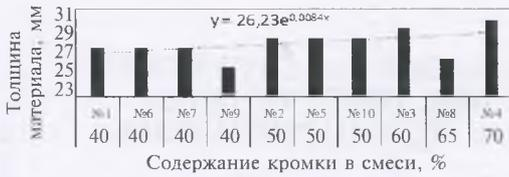
Рис. 2. Зависимость толщины ШНП из РВ от содержания крошки в смеси.
