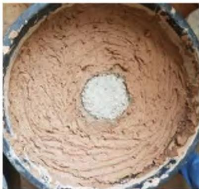
Рис. 1 – Армодрирующий элемент в грунте
