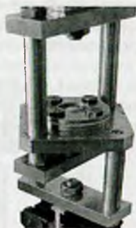
Рис. 4. Универсальное устройство к разрывной машине для оценки деформационных свойств материалов при двухосном растяжении
