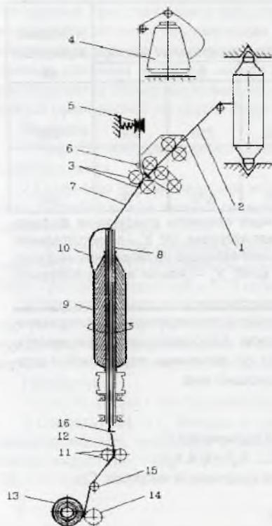
тив часовой стрелки сходящая с него баллонированная нить 10, вращаясь, увлекает за собой мычку с комплексной нитью. На расстоянии от верхушки веретена до переднего цилиндра вытяжного прибора мычка получает необходимое число кручений, превращаясь в пряжу 7 с круткой левого направления.
