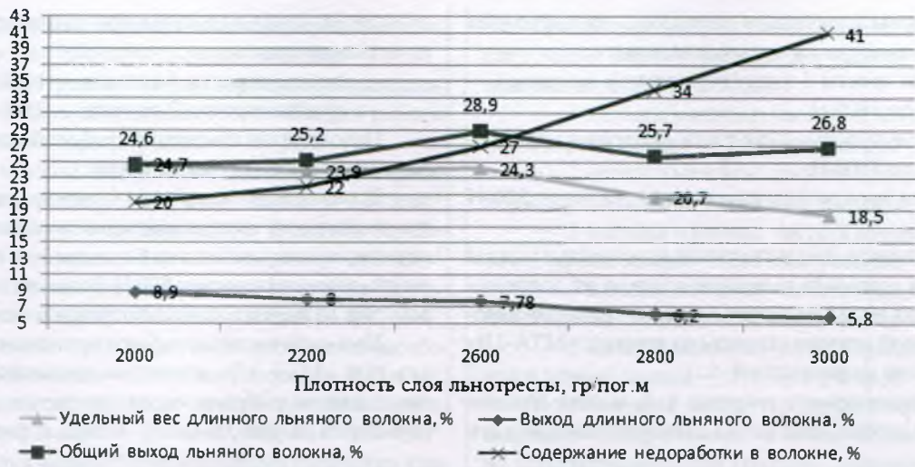
Рис. 2. Зависимость качественных и количественных показателей длинного льняного волокна от плотности слоя льнотресты 2-го типа на слоеформирующей машине агрегата «МТА-2Л»
