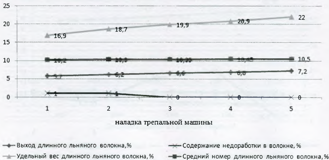
Рис. 8. Зависимость качественных и количественных показателей длинного льняного волокна от частоты вращения трепальных барабанов при переработке льнотресты 2-го типа
