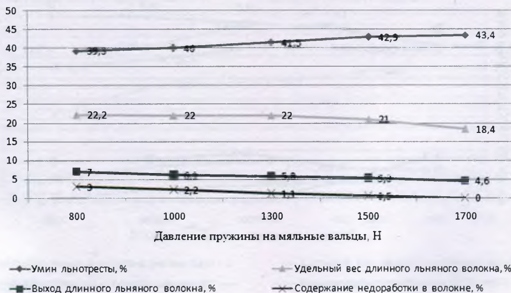
Рис. 6. Зависимость процента умина льнотресты, выхода и качества длинного волокна от давления пружины на мяльные вальцы при переработке льнотресты 3-го типа на агрегате «МТА-2Л»
