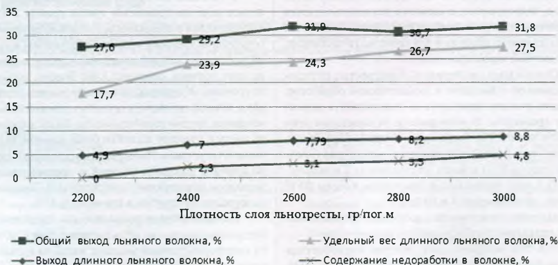
Рис. 1. Зависимость качественных и количественных показателей длинного льняного волокна от плотности слоя льнотресты 1-го типа на слоеформирующей машине агрегата «МТА-2Л»
