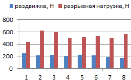
Рисунок 1. – Зависимость разрывной нагрузки и раздвижки в швах при использовании иглы с трехгранным острием – D
