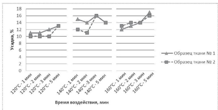
Рис. 1. Графическая зависимость усадки ткани в термокамере от температуры нагрева и времени воздействия на образце
