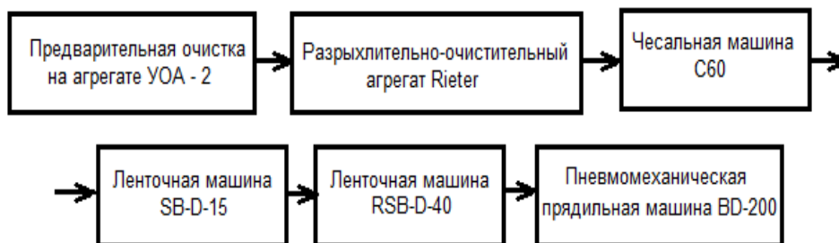
Рисунок 1 – Технологическая цепочка для получения пряжи из отходов производства
