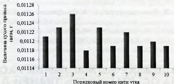
Рис. 4. Величина сухого привеса различных нитей утка тканой основы композиционного материала при концентрации стирол-акрилата — 500 г/л
