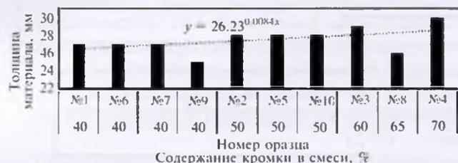
Рис. 2. Зависимость толщины ШНП из РВ от содержания кромки в смеси.
