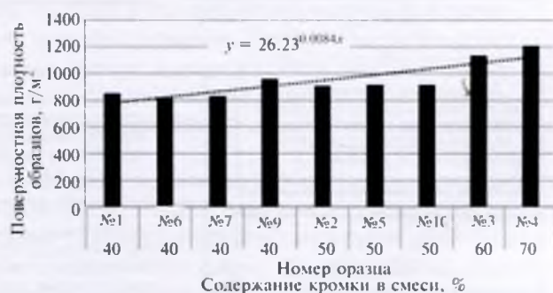
Рис. 4. Зависимость поверхностной плотности ШНП из РВ от содержания в смеси кромки грунтовой ткани.
