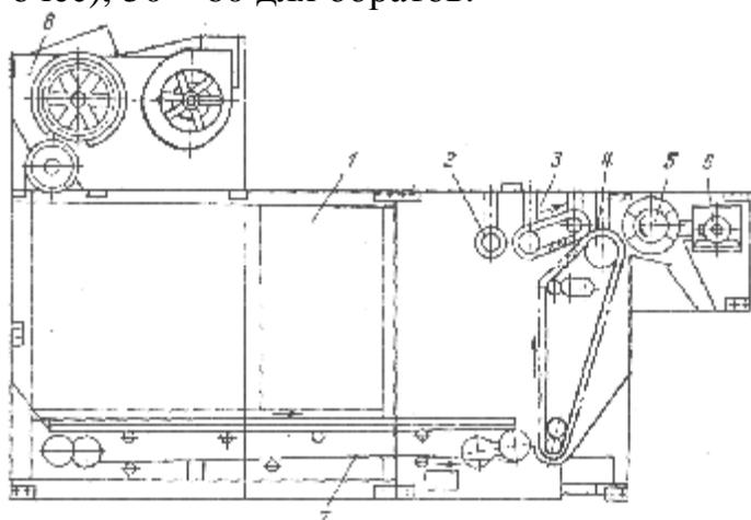
**Рисунок 6 - Технологическая схема смесителя непрерывного действия СН-3У**
