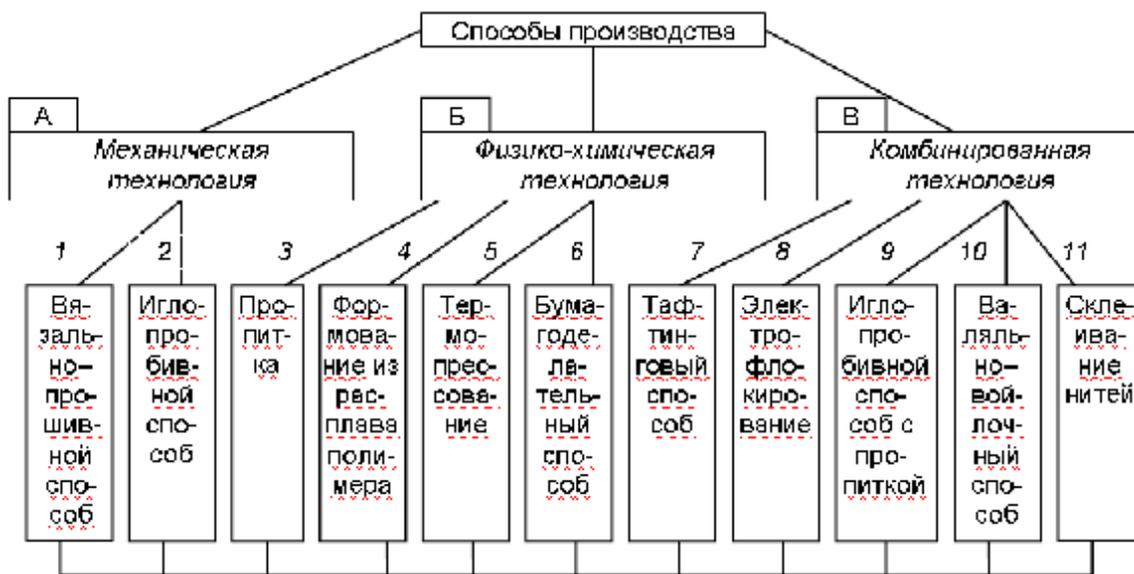
**Рисунок 2 – Способы производства нетканых текстильных настенных материалов**
