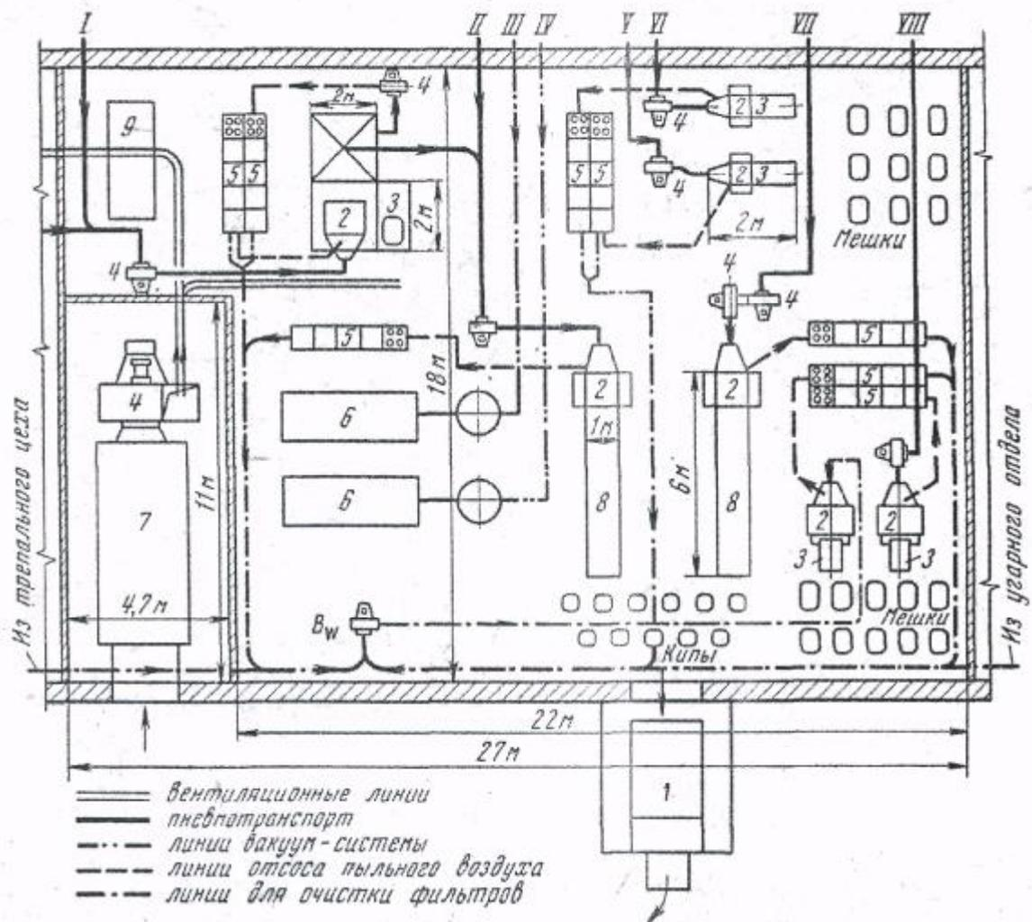
**Рисунок 4 – Схема станции упаковки и разгрузки отходов**
