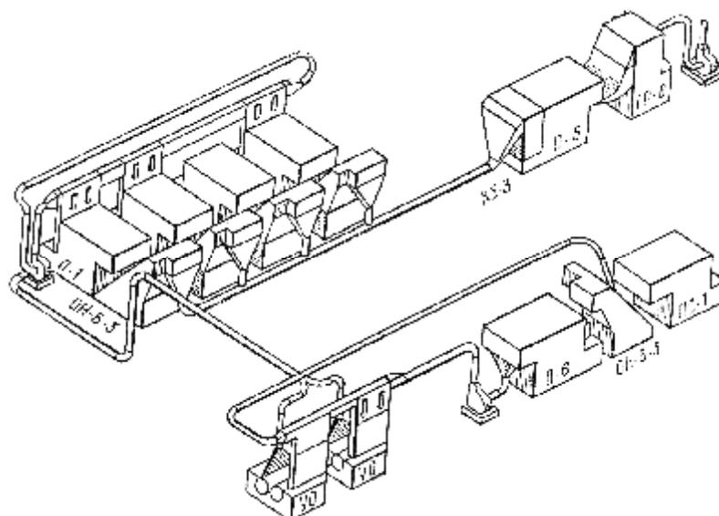
**Рисунок 9 – Разрыхлительно-очистительный агрегат для переработки отходов**
