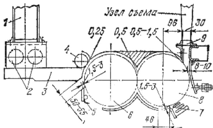
**Рисунок 8 – Технологическая схема пильчатого очистителя**
