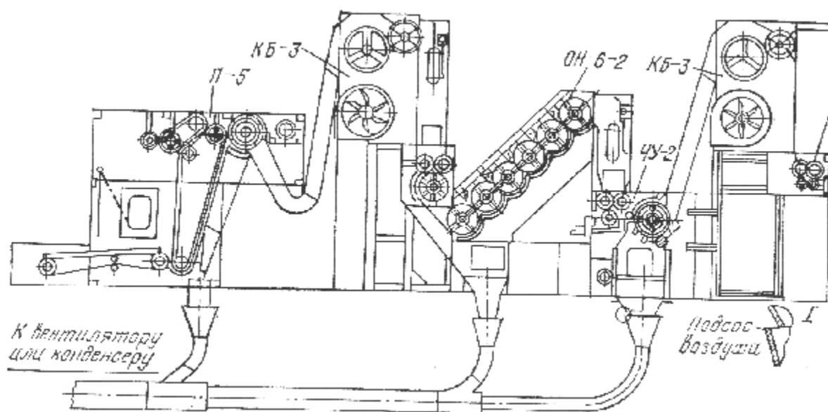
**Рисунок 7 – Технологическая схема угароочищающего агрегата УОА-2**
