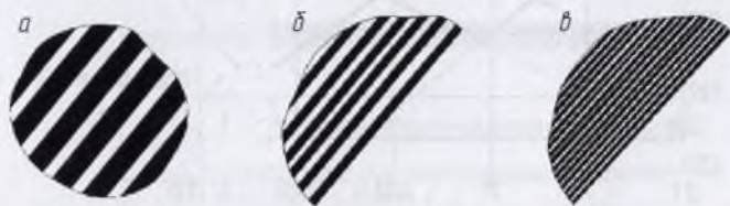
Рис. 1.36. Ферритно-цементитная смесь разной степени дисперсности: а — перлит; б — сорбит; в — троостит
