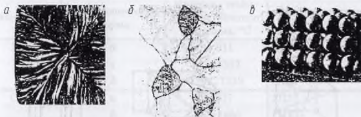
Рис. 1.17. Упрощенная картина кристаллического строения металлов: а — излом меди; б — микроструктура доэвтектической стали с содержанием углерода ~ 0,3 % (светлые участки — феррит, темноватые — перлит, увеличение — \times 250 ); в — кристаллическое строение металла при представлении его атомов в виде мячей
