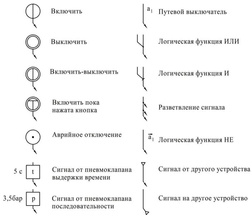
Рисунок 6.6 — Обозначения сигнальных устройств и логических взаимосвязей между сигналами
