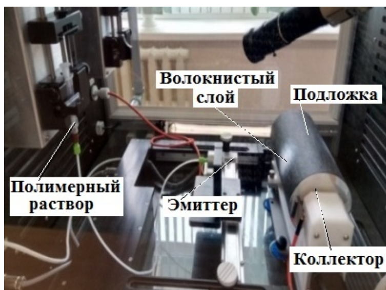
Рисунок 7 – Схема процесса электроформования на установке Fluidnatek LE-50
