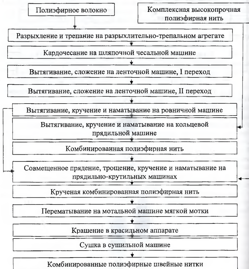
Рис. 11.6. Схема сокращенного технологического процесса получения армированных полиэфирных швейных ниток
