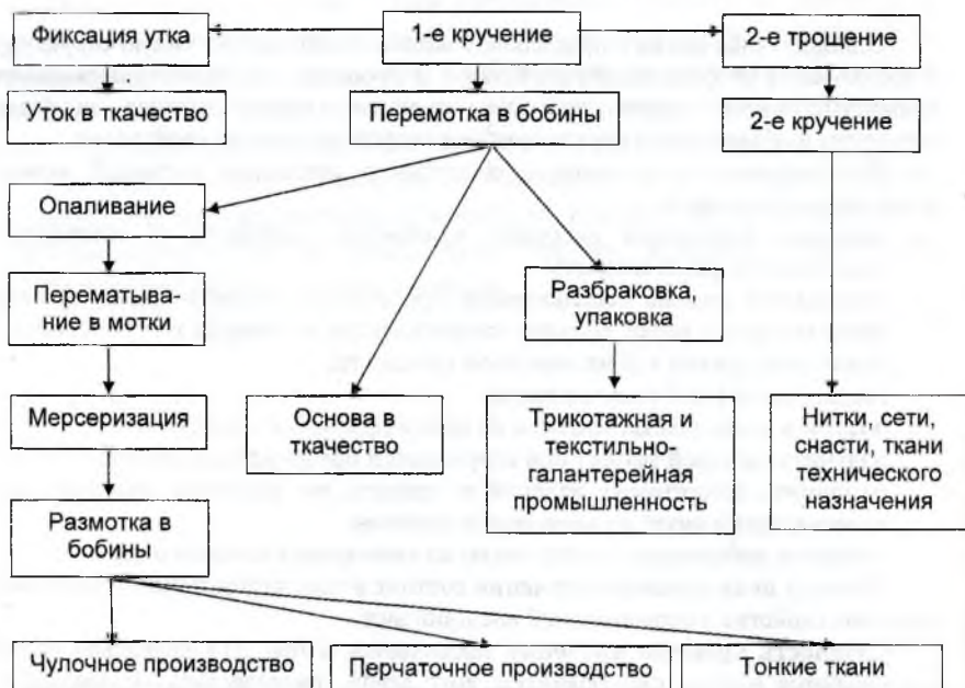
Рис. 1.1. Схема изготовления и область использования крученой пряжи
