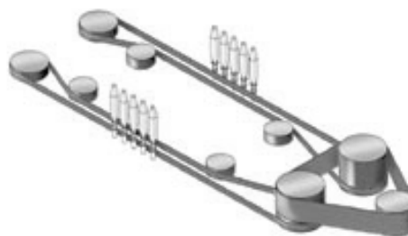
Рисунок 20 – Привод веретен тангенциальным ремнем
