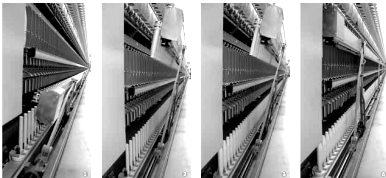
Рисунок 23 – Автоматический сьем початков
