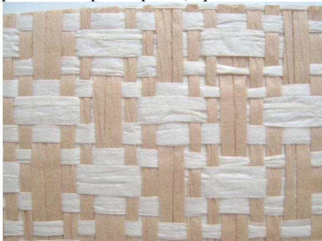
Рисунок 2.6 – Рисунок текстильного композиционного материала
