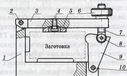
Рис. 1.19. Конструктивная схема зажима:
