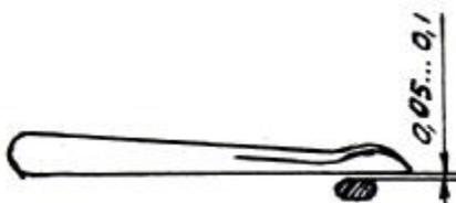
Рисунок 1.7 – Установка зазора между краеобметочным петлителем и иглой
