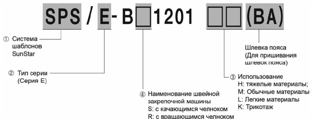
Рисунок 1 – Заводская классификация полуавтоматов серии SPS/E-B1201 фирмы SunStar
