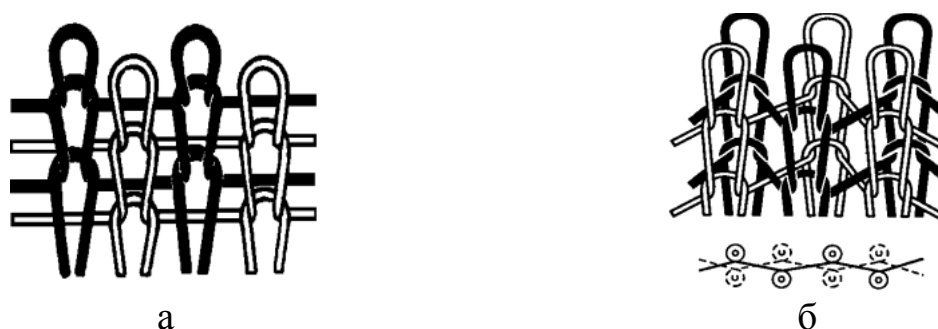
Рисунок 3.13 – Строение и графическая запись переплетений: а – двугладь; б – двуластик (интерлок)
