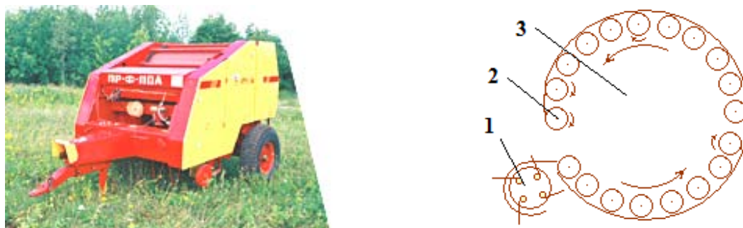
Рисунок 38 – Пресс-подборщик рулонный безременный ПРФ-110Л: 1 – подборщик, 2 – вальцы, 3 – камера прессования
