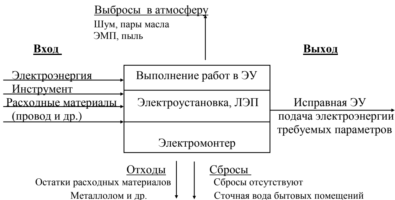
Рисунок П.2 – Схема материальных и энергетических потоков при работе электромонтера в электросетях
