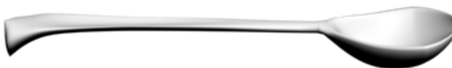
Рис. 7.3.13. Лофтинговый объект, полученный с использованием Fit (Деформация подгонки)
