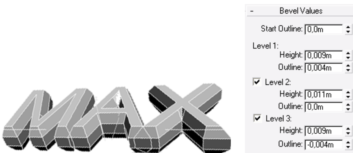
Рис. 6.4. Действие модификатора Bevel (Выдавливание со скосом)
