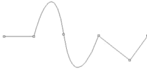
Рисунок 2.2 – Угловые узлы, окружающие сглаженный узел
